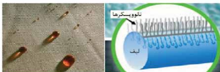
شکل ۱۳. (تصویر سمت راست) قرارگیری نانوتار بلورها به طول ۱۰ نانومتر روی لیف، (تصویر سمت چپ) قطره شدن آب میوه ریخته شده روی پارچه تکمیل شده با نانوویسکرها [۱۶].
