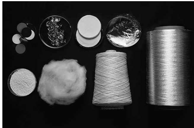
شکل ۱- مواد اولیه به دست آمده از پروتئین تخمیر شده: الیاف پروتئینی، فیلم، پلاستیک و سایر مواد اولیه تولید شده به روش اختصاصی تخمیر کمپانی اسپایبر.
