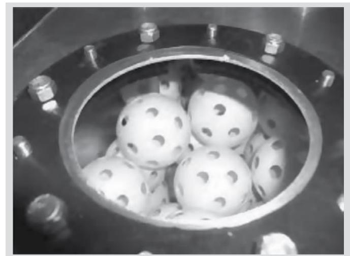
شکل (۵)- پایدارکننده های کروی شکل و نحوه ی قرارگیری آنها در داخل مخزن
