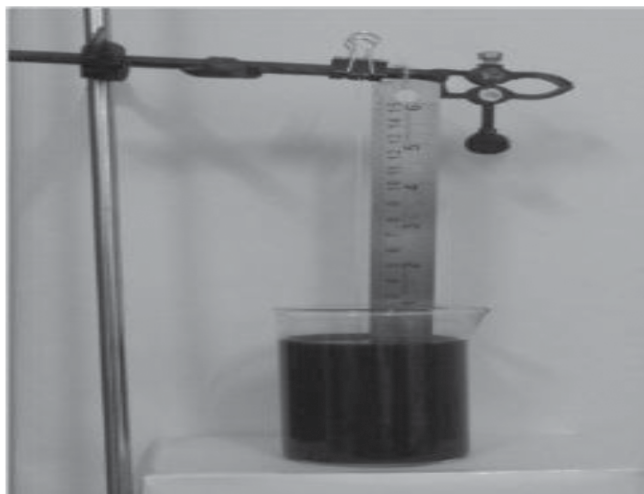
شکل ۴- دستگاه تست عبور رطوبت (مکش) برای نخ
