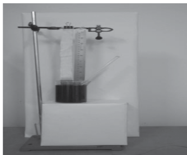
شکل ۴- دستگاه تست عبور رطوبت (مکش) برای پارچه
