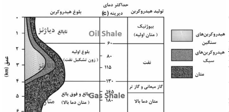
شکل ۴. مقایسه شیل‌های نفتی و گازی از نظر بلوغ حرارتی
