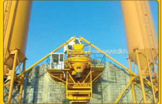
میکسر: افقی با ظرفیت نیم متر مکعب با گیربکس طرح Z-۵۰۰ و الکترو موتور ۳۰ اسب
