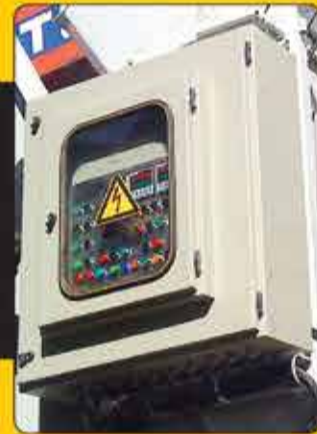
سیستم تابلو فرمان و قدرت: تابلو تمام اتوماتیک با لوازم اشنایدر با قابلیت برنامه ریزی پردازشگر دیجیتالی (سیستم PLC)
