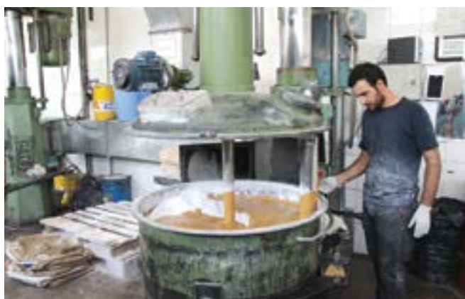
بعد واحد PVC ما است که در آن مواد آماده شده، توزین شده و بنا به نوع تولید با مواد دیگری مخلوط می‌شود.
