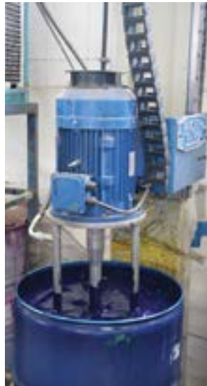
رنگ در پلاستی سایزر آماده شده و ما آن را به مواد اولیه‌مان اضافه کردیم و آنقدر ترکیب کردیم تا به مش استاندارد برسد و با هم همگن بشوند. عموماً این صنعت و بیشتر بخش رنگ‌سازی و ترکیب آن با مواد اولیه جزو کارهای آلوده‌کننده هستند، اما همانطور که می‌بینید ما تا جایی که می‌شود نظافت محیط کار را رعایت کرده‌ایم و اثر چندانی از رنگ بر زمین و لباس‌ها مشاهده نمی‌شود.
