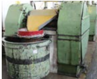
رنگ در پلاستی سایزر آماده شده و ما آن را به مواد اولیه‌مان اضافه کردیم و آنقدر ترکیب کردیم تا به مش استاندارد برسد و با هم همگن بشوند. عموماً این صنعت و بیشتر بخش رنگ‌سازی و ترکیب آن با مواد اولیه جزو کارهای آلوده‌کننده هستند، اما همانطور که می‌بینید ما تا جایی که می‌شود نظافت محیط کار را رعایت کرده‌ایم و اثر چندانی از رنگ بر زمین و لباس‌ها مشاهده نمی‌شود.
