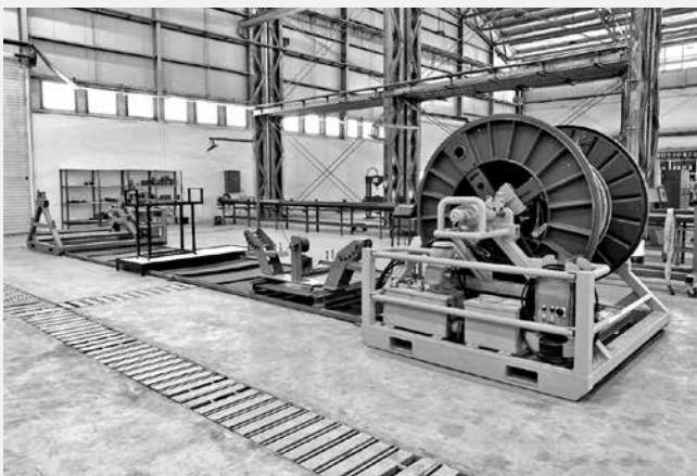
شکل ۹. سیستم تست و ترمیم کابل درون چاهی
