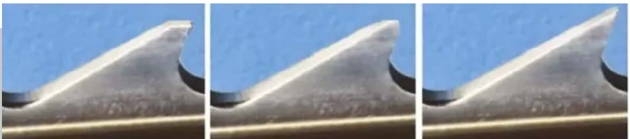
شکل ۱ - وایر نو، وایر قبل از سنگ زنی، وایر بعد از سنگ زنی
