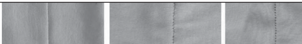
شکل ۱. دوخت پارچه حلقوی با کشش نخ دوخت (الف) کم، (ب) متوسط و (ج) زیاد
